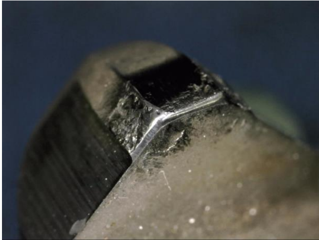
Rys. 1. Zaprojektowane i wykonane ostrze fazownika
