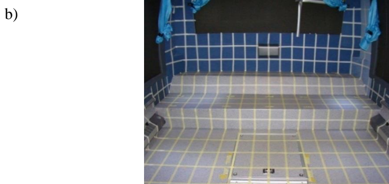
Rys. 15. Płaszczyzna pomiarów: a) położenie płaszczyzn pomiarowych, b) położenie punktów pomiarowych na obiekcie rzeczywistym.
