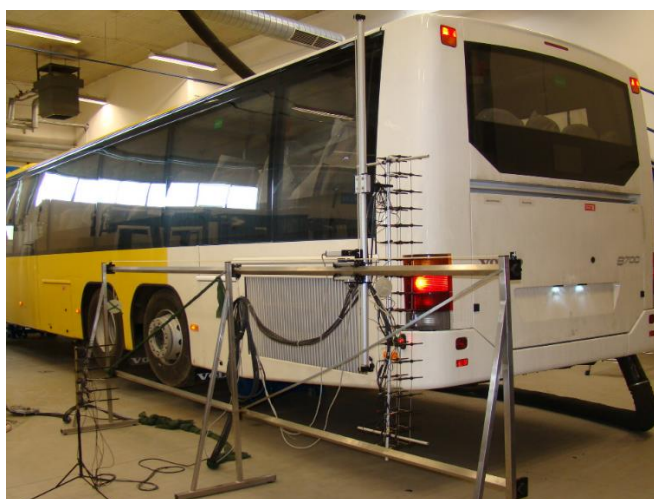
Rys. 18. Widok robota wraz z matrycą mikrofonową w trakcie pomiaru.
