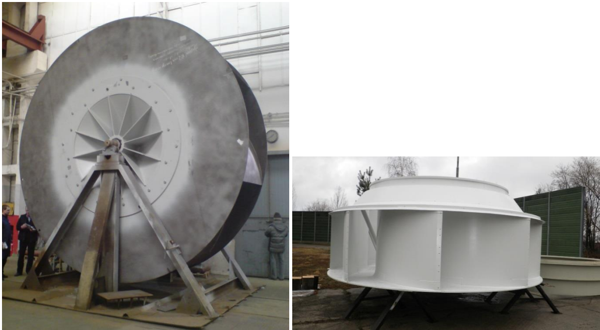
Rys. 3b.1. Nowy wirnik wentylatora promieniowego WPK-5.35 na stanowisku pomiarowym i przygotowany do montażu
