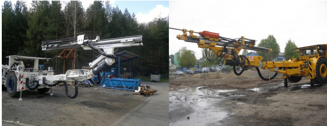
Rys.14. Modyfikowane wiertnice górnicze: FaceMaster 1.7 firmy MINEMASTER SA (lewe zdjęcie) i RWP firmy KGHM ZANAM SA (prawe zdjęcie)
