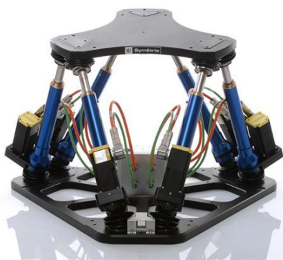
Rys. 1. Widoki mechanizmów równoległych: a) pozycjoner Sirius Hexapod firmy Symétrie; b) mechanizm translacyjny mt - ruu opracowany przez wnioskodawcę
