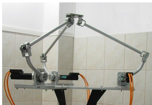
Rys. 1. Widoki mechanizmów równoległych: a) pozycjoner Sirius Hexapod firmy Symétrie; b) mechanizm translacyjny mt - ruu opracowany przez wnioskodawcę
