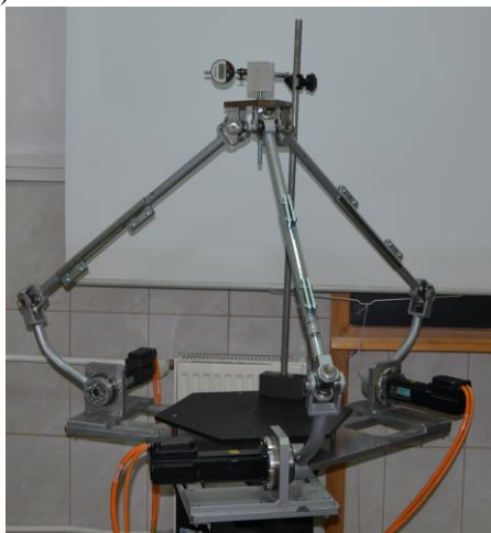
Rys. 10. Widoki translacyjnych mechanizmów równoległych: a) mt-ruu ; b) mt-utu
