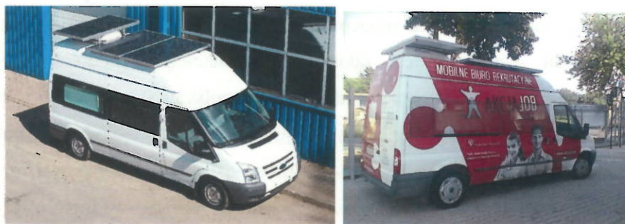
Rys. 7. Mobilne biuro wyposażone w wysokowydajny układ wspomagania zasilania elektrycznych urządzeń pokładowych z zastosowaniem ogniw fotowoltaicznych
