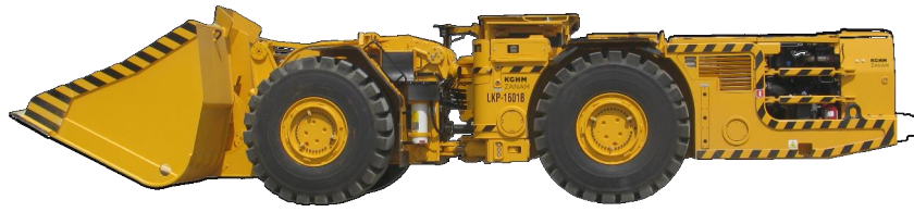
Rys. 6.9./ adowarka kopalniana LKP-1601B [ ród6: KGHM ZANAM S.A.]
