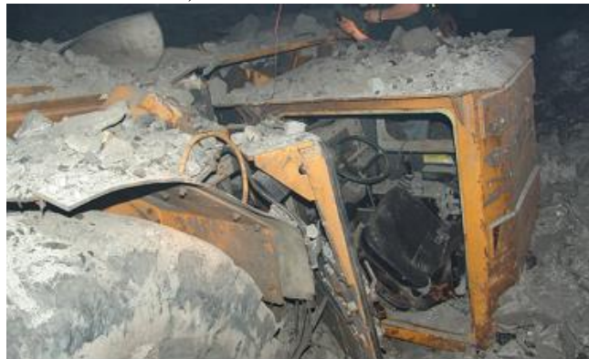
Rys. 5.2. Miejsce wypadku śmiertelnego operatora ładowarki budowanego skutkiem wyprężenia spogu - konstrukcja RSPS.
