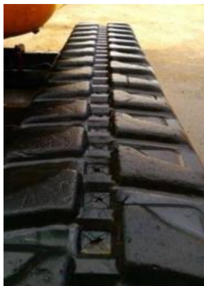
Rys. 14. Gąsienica elastomerowa G2, próbka w stanie poeksploatacyjnym wynoszącym 1228 motogodzin
