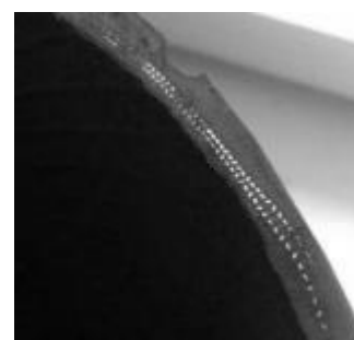
Rys. 19. Przekrój poprzeczny przez oponę samochodową wyprodukowaną po 1999 r., widoczny stalowy kord
