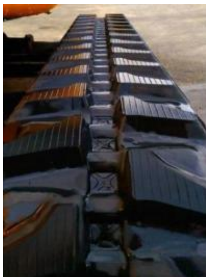
Rys. 13. Gąsienica elastomerowa G1, próbka nieeksploatowana
