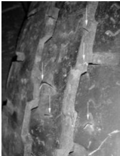
Rys. 8. Uszkodzona opona nr 1, widoczne fragmenty drutów z przerwane opasania, które przebiły bieżnik opony
