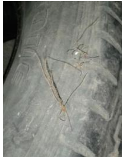
Rys. 9. Uszkodzona opona nr 2, widoczne fragmenty drutów z przerwane opasania, które przebiły ściankę boczną opony
