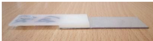
Złącze hybrydowe polimer-metal (próbka jednozakładkowa do badań wytrzymałości na ścinanie)
