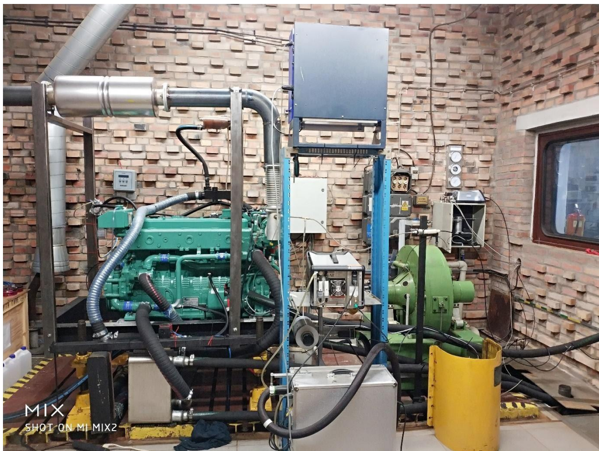
Rys. 2. Silnik wraz z hamulcem elektrowirowym podczas testu na hamowni silnikowej
