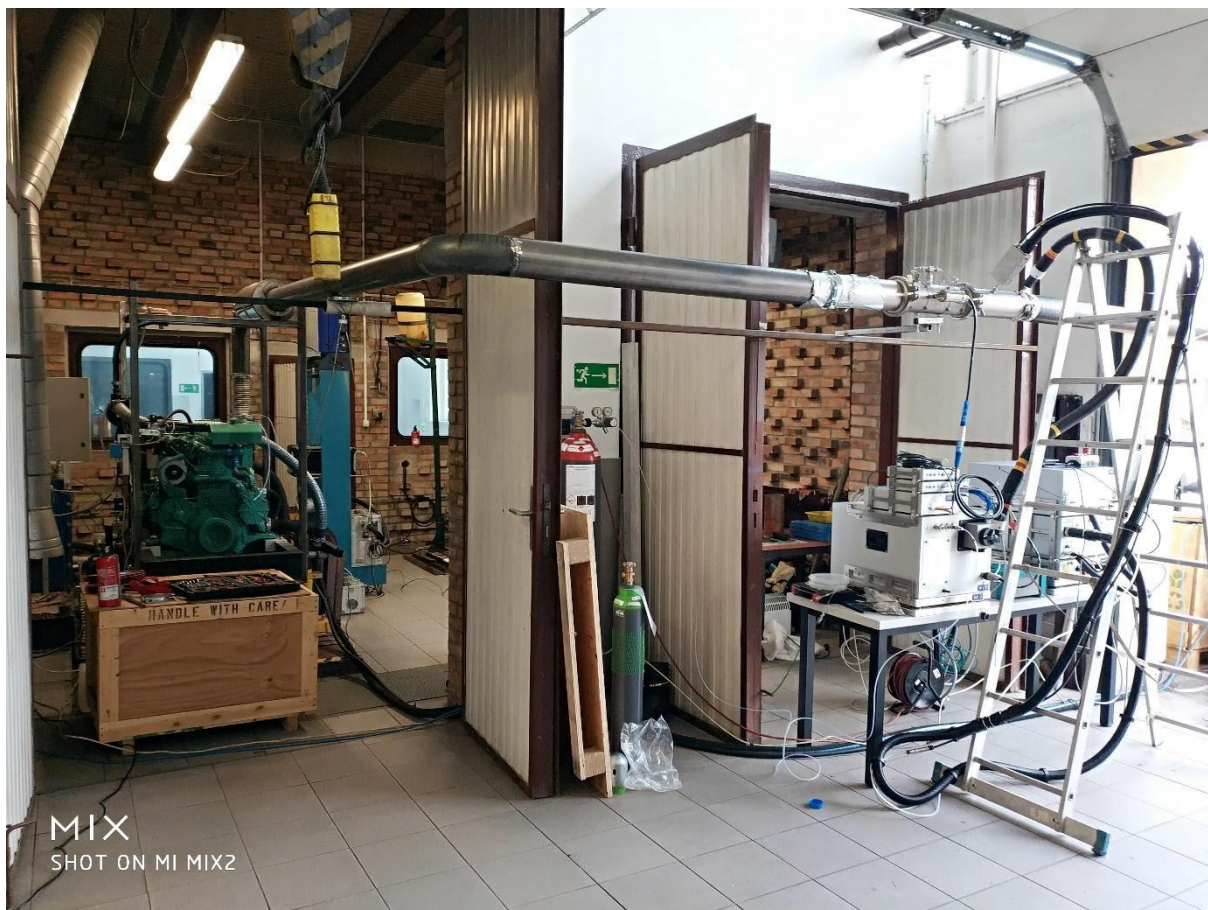
Rys. 1. Stanowisko hamowniane zgodne z ISO 8178 do badań homologacyjnych silników spalinowych typu „off-road”
