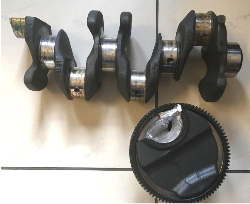
Rys.1. Widok ogólny dostarczonego uszkodzonego wału pochodzącego z samochodu BMW X3
