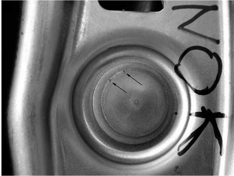
Rys.1. Powierzchnia łba zakutego nita, widoczne poprzeczne pęknięcia (zaznaczone strzałką)
