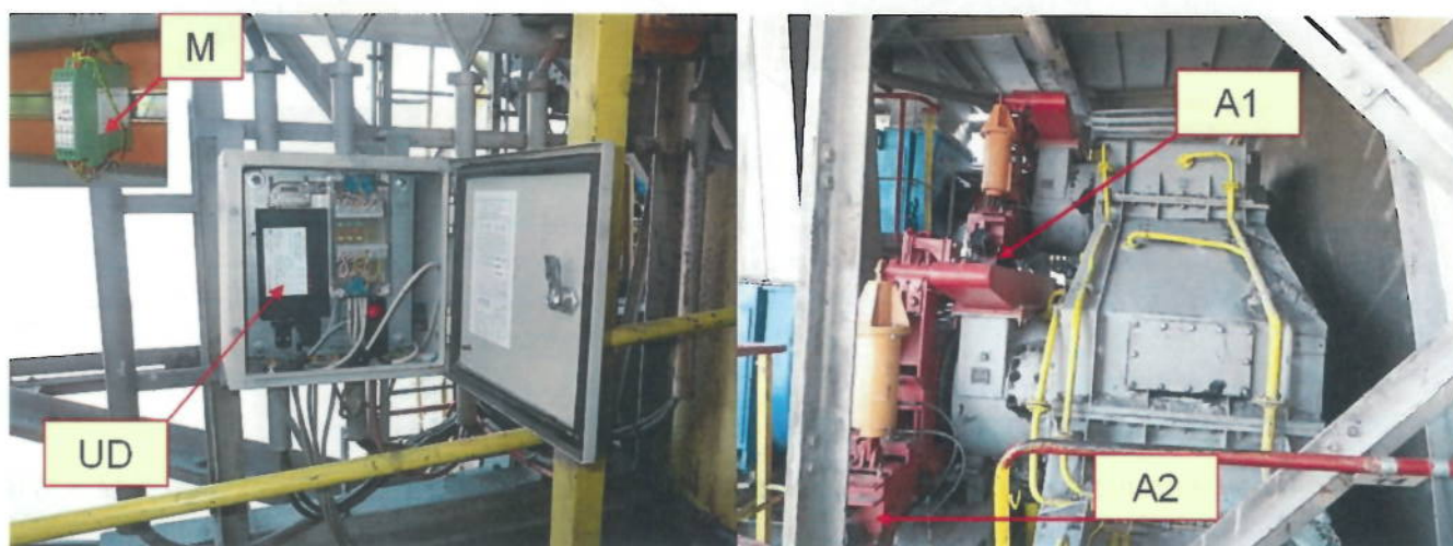
Rys. 13. Elementy układu zabezpieczającego na koparce K41: UD – układ sterujący, A1 i A2 – układy wykonawcze na hamulcach przeciążeniowych górnym (G) i środkowym (S), M – modyfikator prędkości zadanej w kabinie operatora tylko na K41 pośredniczy w sterowaniu analogowym układem sterowania napędami obrotu nadwozia, na K42 i K43 układy sterowania są programowalne i sterowane bezpośrednio z UD
